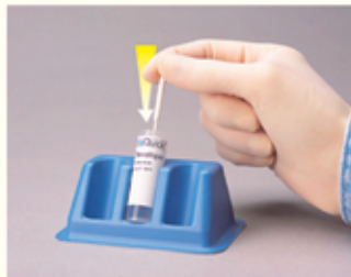
테스트 기구 안에 혈액이 든 루프 넣기
